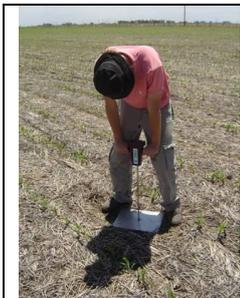
**Medición a campo de la resistencia mecánica del suelo a través de un penetrómetro digital con datalogger.**
